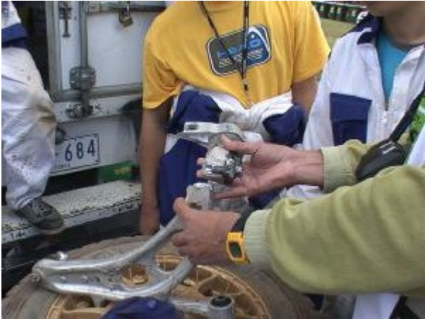
昨夜の1号車の交換部品を見てその衝撃の強さに驚く学生たち一同。ロアアームが折れてしまっていま
